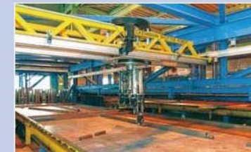
1.周辺型枠のセット
