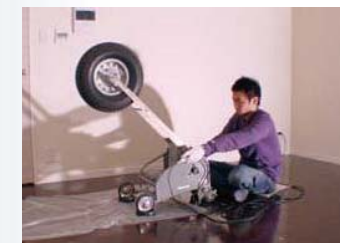
床衝撃音実験(加振室)
